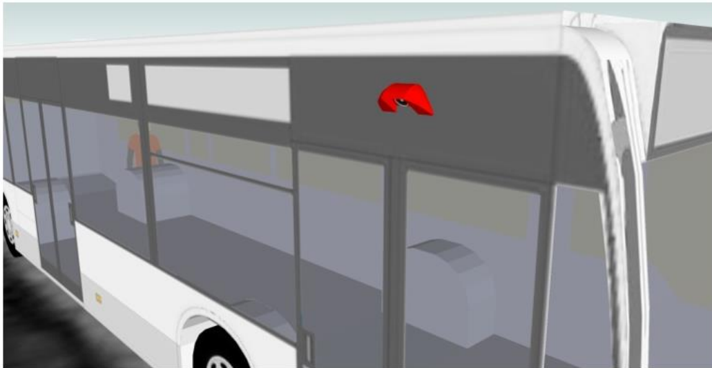
Figur 4, Exempel på skärmutformning för högtalare.
